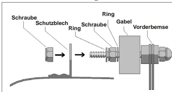
1) Entfernen Sie die Schraube sowie den Bolzen und halten dann das Schutzblech an die Vordergabel
