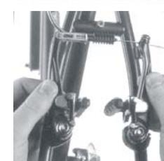
Mutter auf der Hinterseite des Schuhs/Klotzes und schieben Sie die Klötze dichter zur Felge. Drehen Sie diese Mutter wieder gut fest. Achten Sie darauf, dass Sie sowohl den linken als auch den rechten Bremsschuh/Klotz auf denselben Abstand von der Felge einstellen. Wichtig ist, dass der Bremsschuh/Klotz so hoch eingestellt ist, dass beim Bremsen der Schuh/Klotz nicht unter die Felge geraten kann. Weiter siehe unsere Abbildungen.
