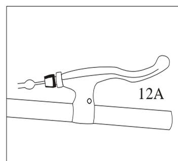
**HINWEIS :** Sollte eine weitere Einstellung der Bremsen notwendig sein, können Sie Den Abstand zwischen Bremsschuhen und Felgen verändern, indem Sie die Justierschraube entgegen der Uhrzeigerrichtung drehen.
